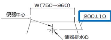
・排水管(VP・VU75)は床仕上げ面と同一面で立ち上げてください。
